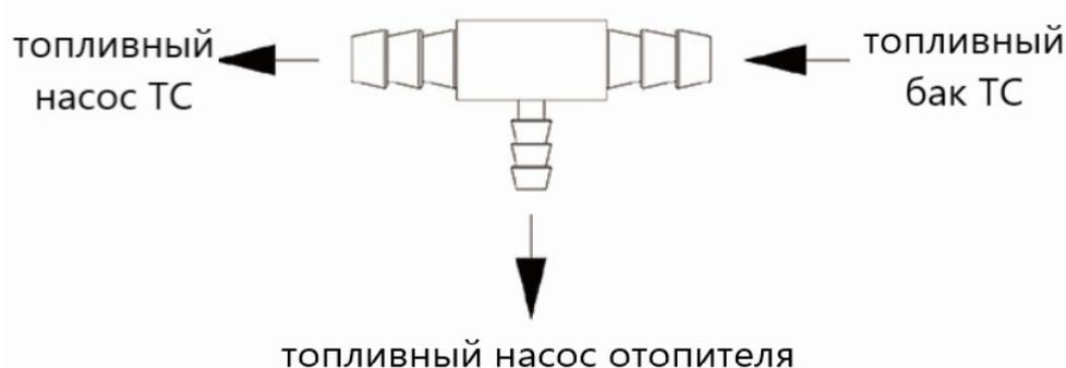
Топливопровод должен быть хорошо закреплен. При прокладке топливопровода необходимо соблюдать осторожность, чтобы избежать растяжения, сжатия, трения или вибрацию топливопровода.
