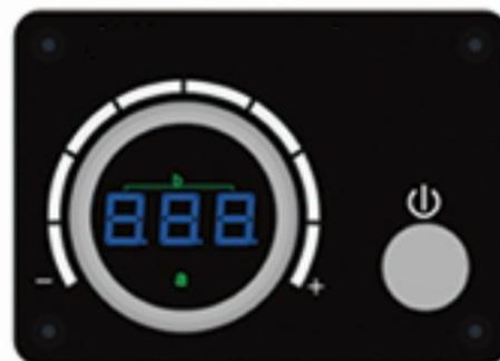
В режиме «по температуре» регулятором можно установить температуру от 18°C до 45°C. Датчик температуры находится в пульте управления. Отопитель будет нагревать воздух в помещении до выставленной температуры.
